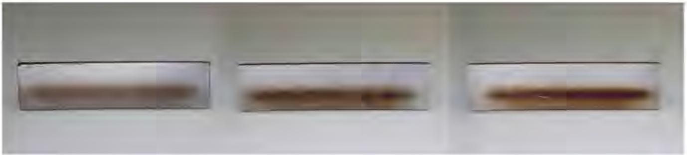
**Figura 8:** Confronto dei colori di rinvenimento in fondo alla pagina; a sinistra forceArc puls, al centro forceArc, a destra processo a impulsi
