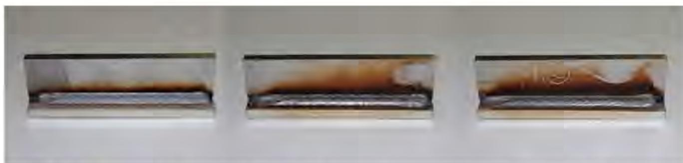
**Figura 7:** Confronto dell'aspetto del cordone e del colore di rinvenimento, lamiera  $t = 10$  mm, DV = 13 m/min; a sinistra forceArc puls, al centro forceArc, a destra processo a impulsi
