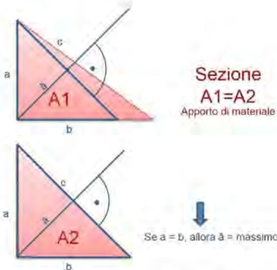
**Figura 9:** Confronto delle superfici della sezione e della misura a massima risultante
